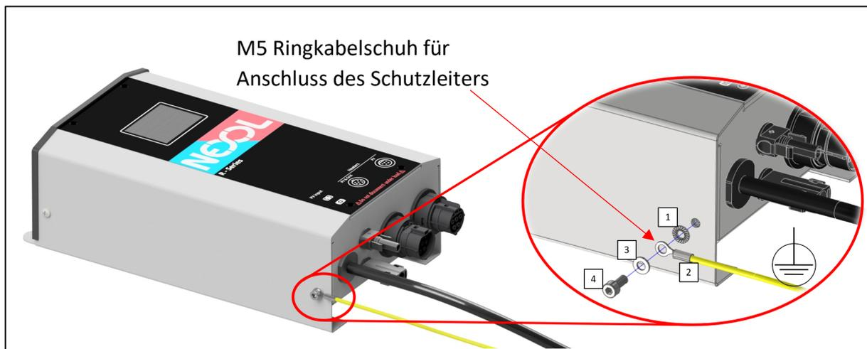
Abbildung 16: Schutzleiteranschluss des Nexol Energy Controllers
