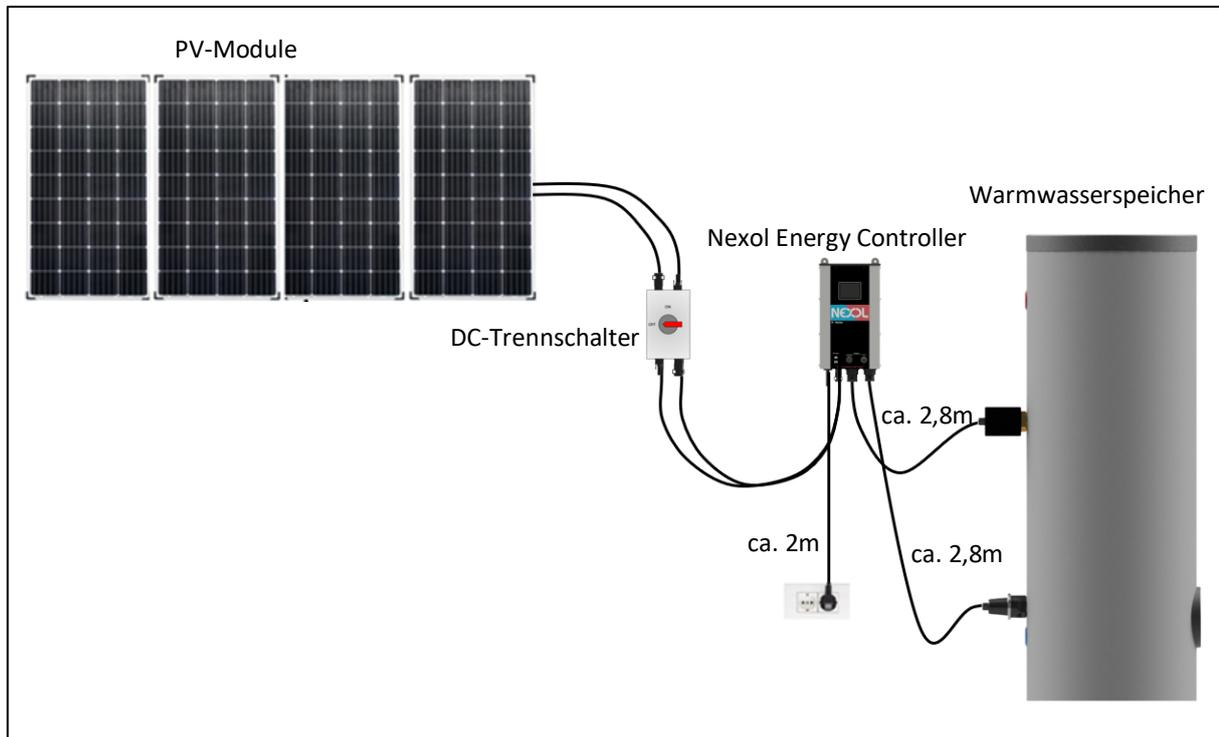
Abbildung 12: Schema Installation des Gesamtsystems
