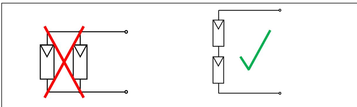
Abbildung 20: Schemazeichnung Anschluss der PV-Module in Reihe
