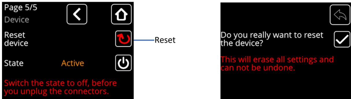
Abbildung 32: Einstellmöglichkeit Reset
