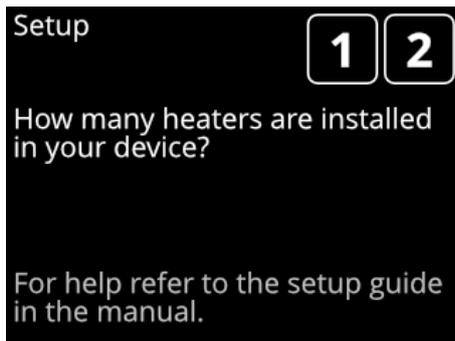
Abbildung 23: Ersteinrichtung Anzahl der Einschraubheizkörper festlegen
