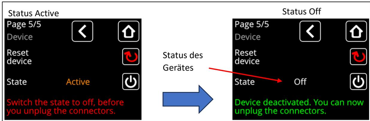
Abbildung 33: Einstellmöglichkeit Trenn-Modus zum Entfernen der Stecker
