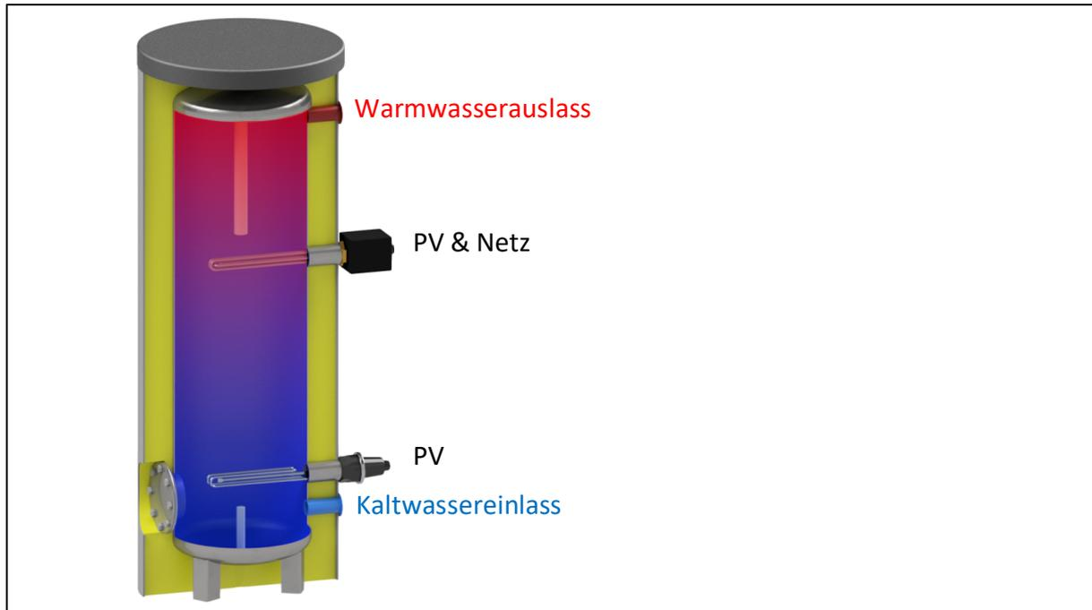
Abbildung 2: Teilschnitt eines Warmwasserspeichers mit installierten Einschraubheizkörpern
