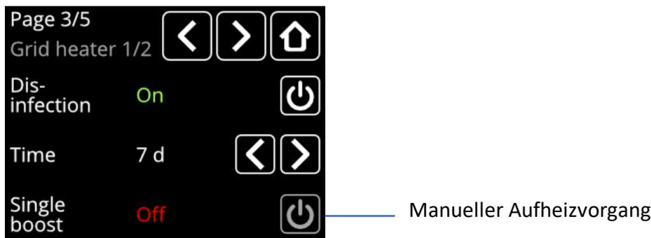
Abbildung 31: Einstellmöglichkeit manueller Aufheizvorgang / Single boost
