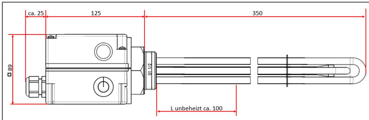
Abbildung 8: Abmessungen Einschraubheizkörper für PV und Netzbetrieb
